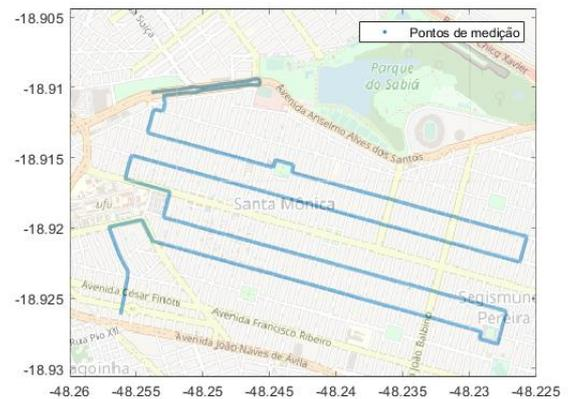
Foram coletadas 71 000 amostras de intensidade do campo elétrico, no percurso definido. O setup de recepção escolhido, armazenou-se os parâmetros (latitude, longitude, distância, altitude e campo elétrico) das amostras coletadas. Na sequência realiza-se uma análise dos parâmetros, a fim de definir as entradas e saídas da RNA.
