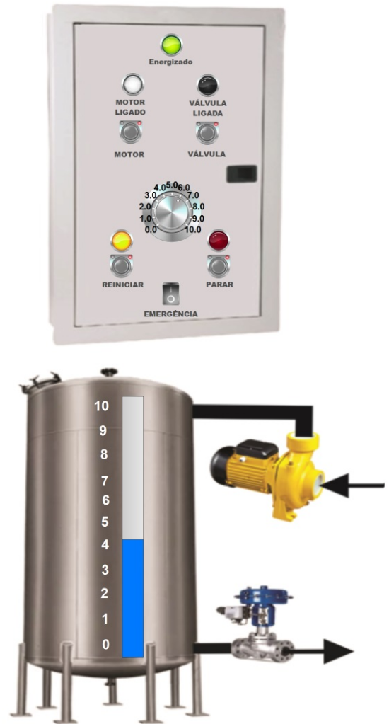
Figura 3: SoftPLC implementado com CODESYS.
