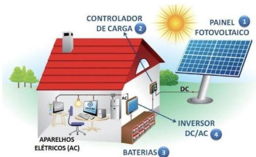
Na Figura 4, temos a representação do sistema fotovoltaico híbrido, onde tem-se um sistema conectado a rede que está integrado a um banco de baterias. Sendo assim, este é um sistema mais completo e de maior confiabilidade, uma vez que o consumo pode continuar,
