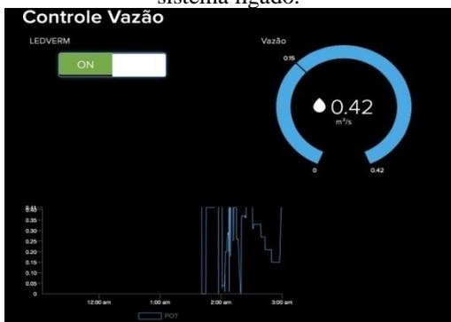
A figura 13 mostra a coleta da variação dos dados da vazão via web através da transmissão via *wifi* com o sistema moto-bomba desligado.
