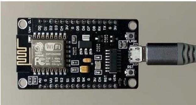
Figura 4: Definição de pinos Nodemcu.
