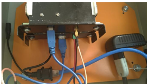
Figura 4: Ligação entre o RAK833 e a Placa Viola Carrier.
