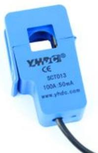
Este tipo de sensor não precisa interromper o circuito para que seja feita a medição, ele adquire os valores de corrente através do campo magnético gerado com a passagem de corrente pelo cabo o qual ele envolve. Estes valores são transmitidos ao microcontrolador onde são tratados.
