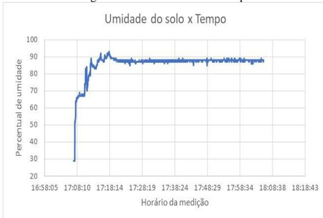
A medição durou cerca de 1 hora, o sistema manteve-se ligado por aproximadamente 10 minutos até atingir o limite máximo de umidade definido (93%), quando a irrigação desligou. Após isso a umidade do solo manteve-se praticamente constante até o fim do experimento, estabilizando-se em cerca de 88%.
