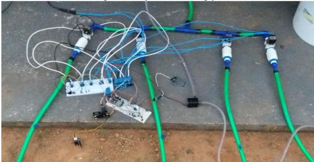
O sensor capacitivo foi calibrado antes de ser instalado em campo. Para fazer a calibração usou-se um recipiente de 300 ml de capacidade, contendo terra seca, e foi-se adicionando amostras de 10 ml de água até o solo atingir a saturação.
