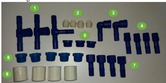
Na figura 2 os números correspondem a um tipo de conexão específica, a saber: (1) 02 têes 1/2" (polegada) x 1/2" x 3/4" e 01 tê 1/2" x 1/2" x 1/2"; (2) 04 plugues roscáveis 1/2"; (3) 02 curvas 1/2" x 3/4"; (4) 04 conectores 1/2" roscáveis; (5) 03 adaptadores roscáveis 1/2"; (6) 05 adaptadores roscáveis 3/4";
