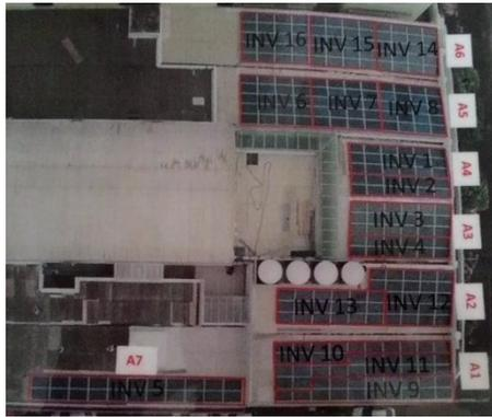
Nesse sistema são utilizados três tipos de inversores diferentes, de um mesmo fabricante, porém de cargas diferentes. Os equipamentos possuem potência nominal de 2,9 kW, 3,8 kW e de 4,4 kW - modelos *Theia He-t 2.0*, *Theia He-t 3.8*, *Theia He-t 4.4* da *Eltek* [6], respectivamente. Cada arranjo abrange uma certa quantidade de inversores próprios para a quantidade de placas instaladas e a potência gerada por elas.
