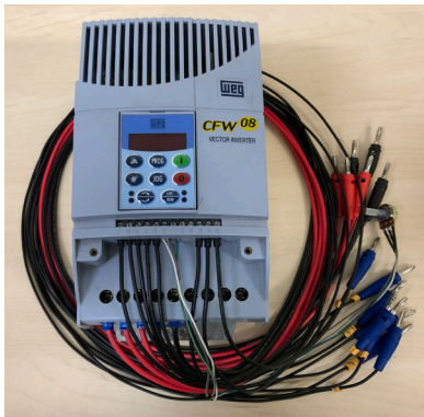
Figura 13: Inversor de frequência com plug tipo banana.
