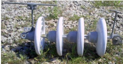
Figura 5: Cadeia de isoladores com dispositivo centelhador.
