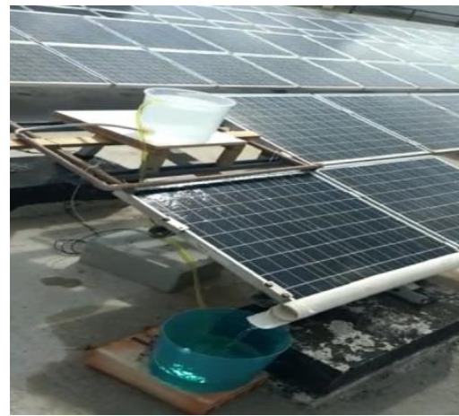
Figura 3: Placa arrefecida por água.
