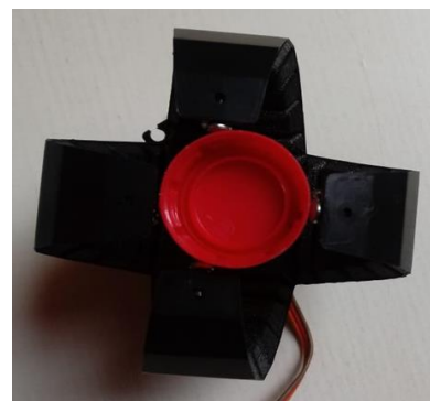
Figura 6: Garra robótica agarrando uma tampa de refrigerante.
