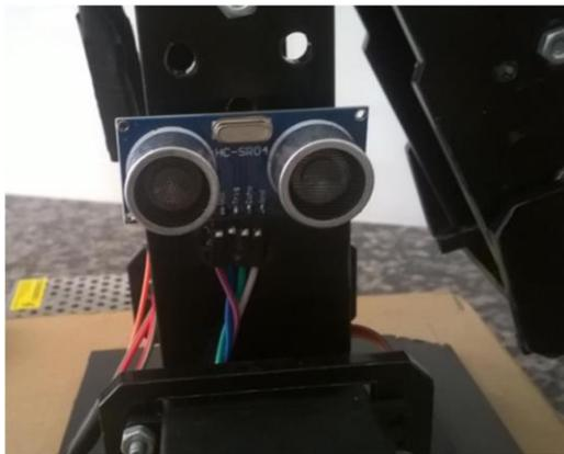
Figura 9: Sensor Ultrassônico
