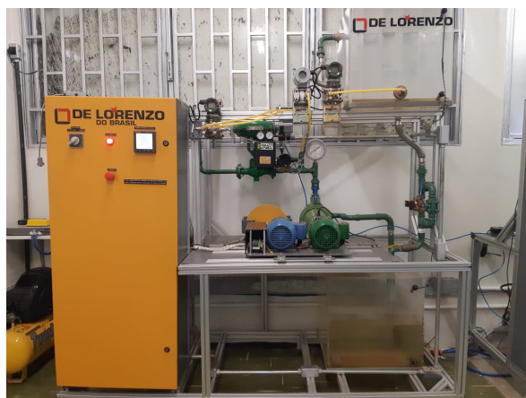
Figura 2: Bancada do Sistema de Bombamento.
