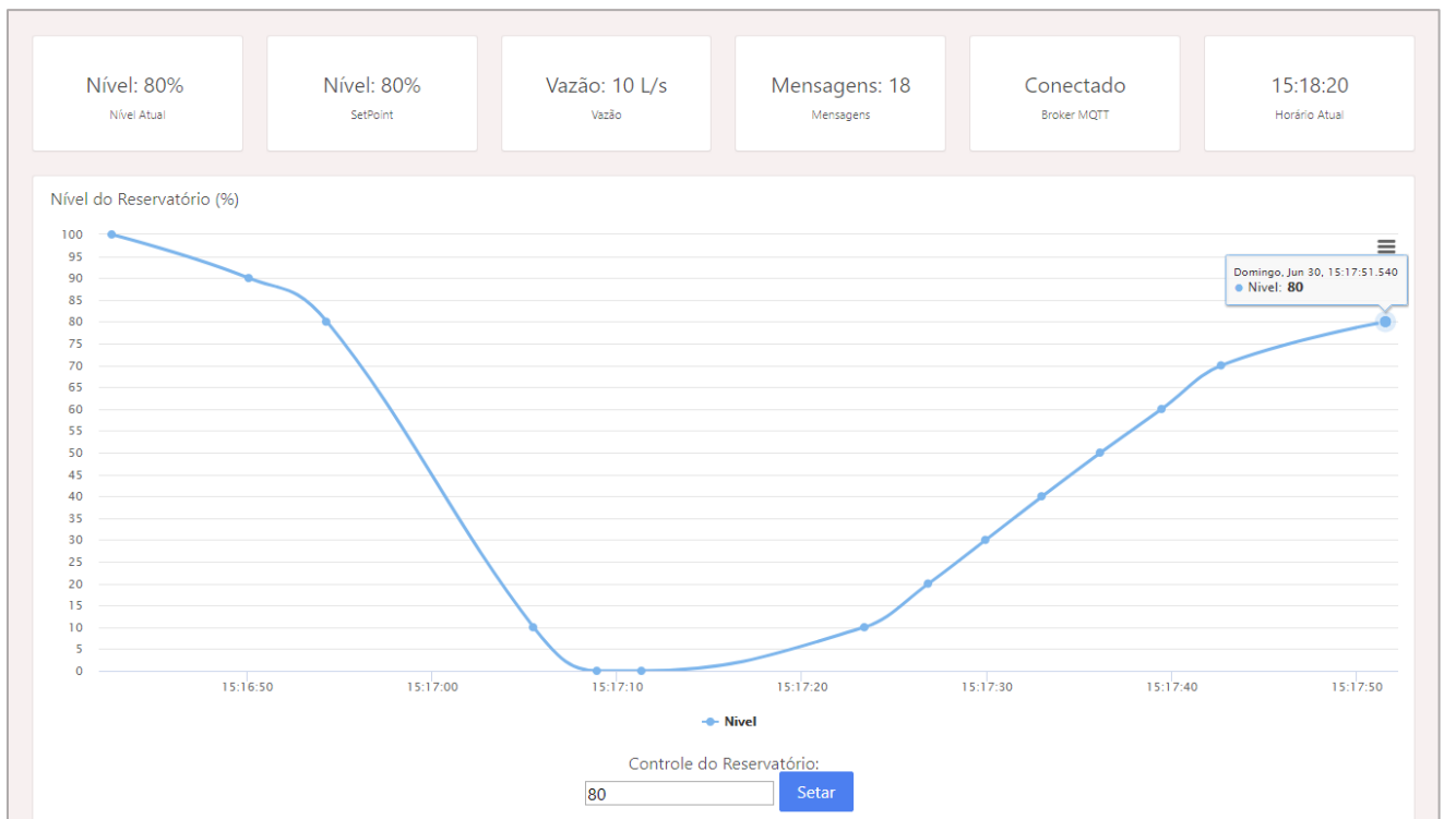
Figura 3: Interface do supervísório na WEB.
