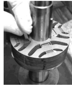
Fig. 4. IPs sendo inseridos na barreira de fluxo do rotor MSR. Fonte N. Bianchi [1].
