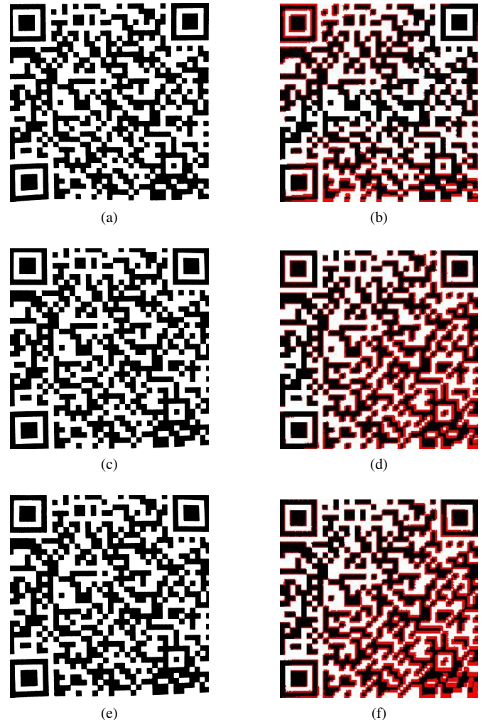
Figura 8: Imagens resultantes da Binarização em Sub-regiões para o QR Code 3 nos padrões de (a) Iluminação 1, (c) Iluminação 2 e (e) Iluminação 3, com suas respectivas imagens diferença em (b), (d) e (f).
