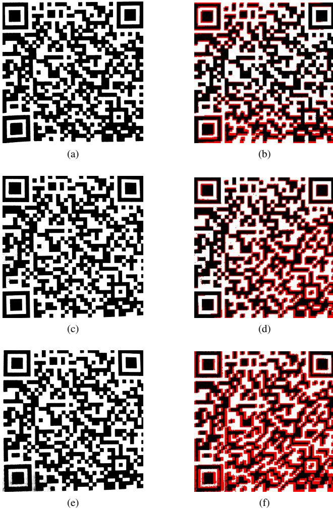
Figura 7: Imagens resultantes da Binarização Pós Equalização por Histograma para o QR Code 3 nos padrões de (a) Iluminação 1, (c) Iluminação 2 e (e) Iluminação 3, com suas respectivas imagens diferença em (b), (d) e (f).
