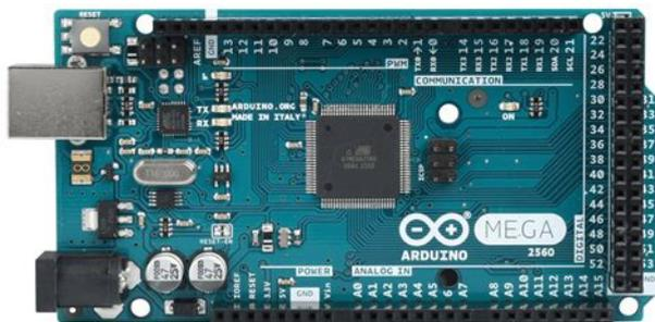
No Arduino MEGA existem 6 pinos de interrupções externa [6]. As interrupções externas são pinos para disparo de interrupção tanto na borda de subida ou descida, ou em níveis lógicos alto ou baixo e tem como funcionalidade ler sem pausas o estado de uma determinada porta [5].
