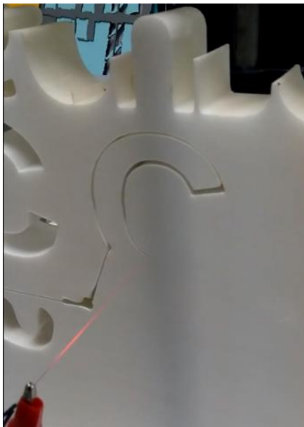
Figura 1: Corte de XPS com fio quente.
