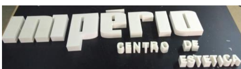
Figura 17: Resultado do primeiro corte em XPS.
