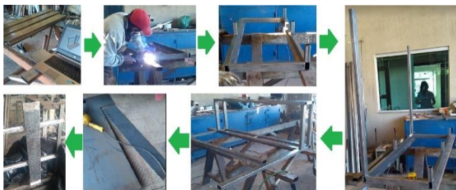
Figura 11: Fabricação da estrutura da CNC fio quente.
