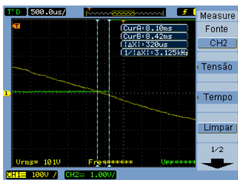
Figura 8: Medição do sinal de saída do detector de zero ligada ao Arduino pino 3.
