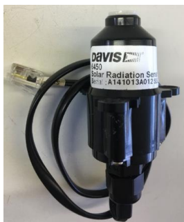
Figura 7: Sensor solar Davis 6450. Fonte: Própria.
