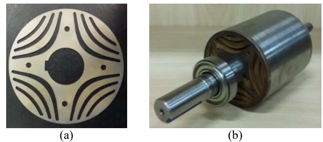
Figura 7: Lâmina cortada (a) e rotor construído (b) para o MSR segunda geração.
