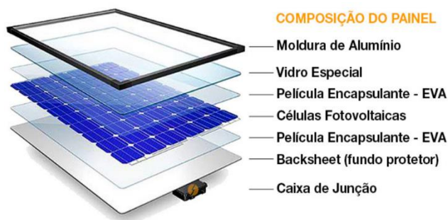
Figura 1: Representação de todas as camadas presentes dentro de um módulo fotovoltaico, retirado da referência [3].
