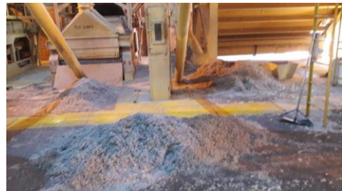
Figura 3: Sujeira proveniente de transbordamentos.
