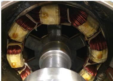
Figura 8: Relação entre os polos do estator e do rotor no protótipo.
