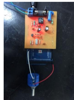
Figura 9: Teste em laboratório com potenciômetro multi-voltas com o objetivo que controlar a tensão.
