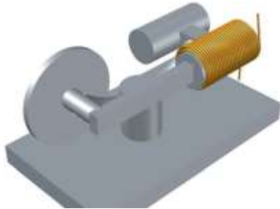
Figura 2: Representação do acoplamento do solenoide no motor baseado no ciclo Stirling
